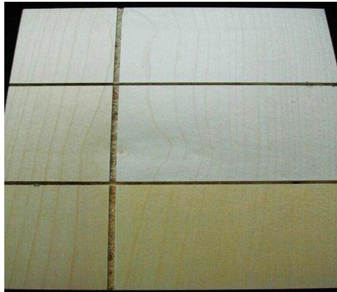
Изменение цвета в коричневый отбеленных деревянных поверхностей при использовании неподходящих PUR – систем. Реакция между пероксидом (средство для отбеливания) и изоцианатом (PUR – отвердитель).
