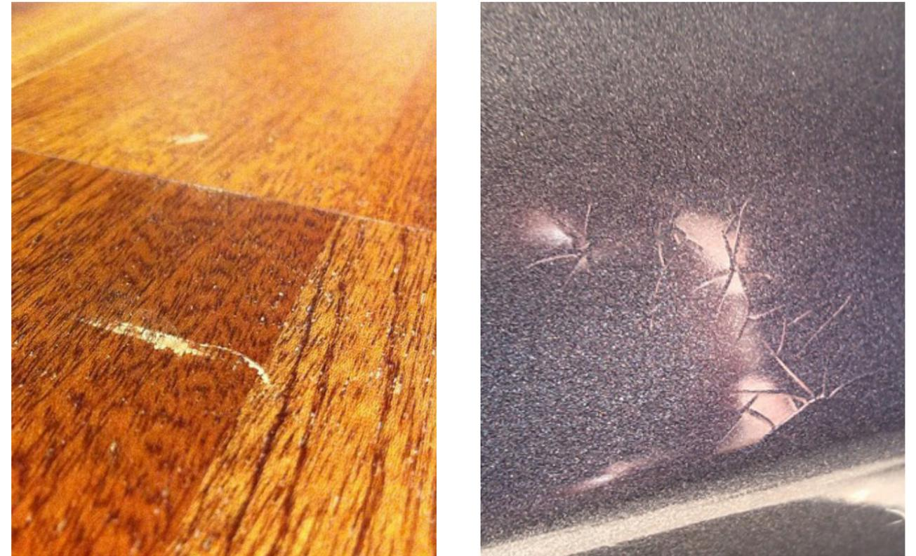
Наличие не связанных между собой трещин разной ширины, длины и глубины на поверхности эмали. Происходит этот дефект из-за ослабления слоя лака под воздействием окружающей среды.
